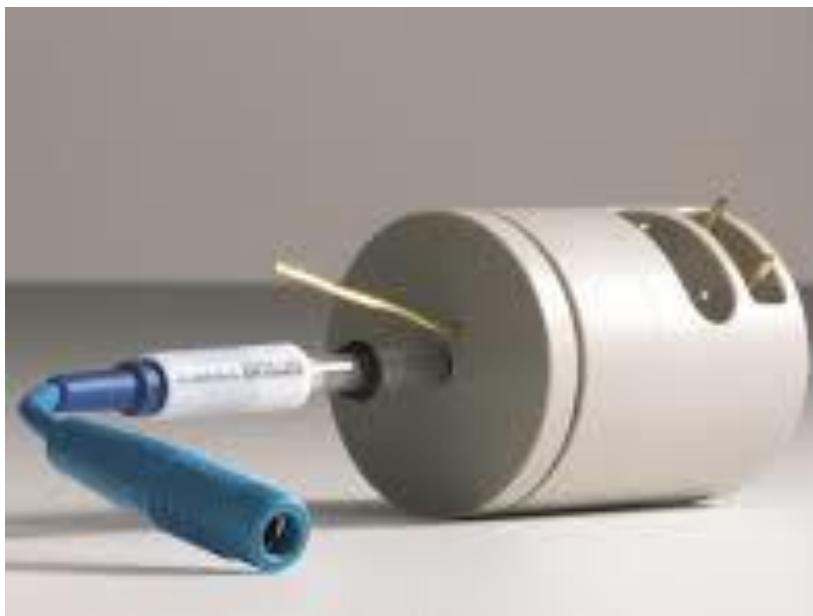
(A) Configuración de una celda de tres electrodos. (B) Vista interior de la celda.
